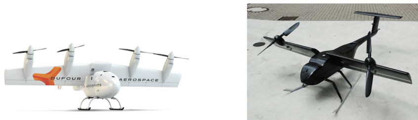
FIGURE 1.4 – Structure tiltwing proposée par [Dufour 2024, Ostermann 2012].
