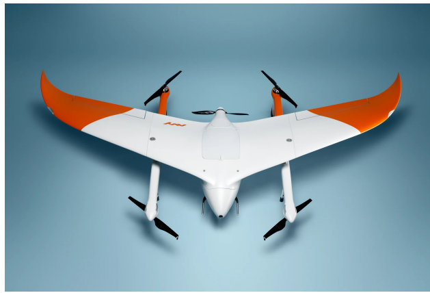
FIGURE 1.1 – Structure quadplane proposée par [Avy 2023].
