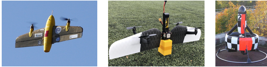
FIGURE 1.3 – Structure tiltrotor proposée par [Smeur 2020, Fernandez 2023b, Pffimlin 2006].
