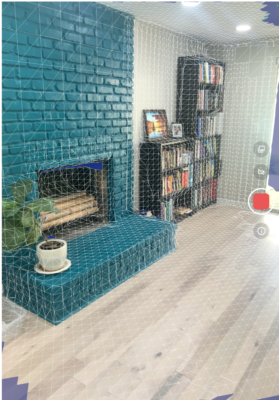
FIGURE 5.2 – Prévisualisation du maillage lors de l'acquisition des données LiDAR par l'application Polycam à l'aide du LiDAR intégré dans les appareils Apple.
