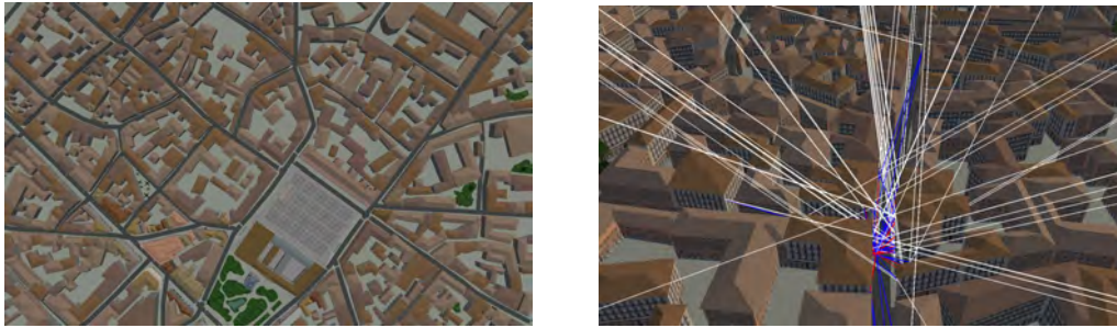
A. Vue aérienne centrée sur le Capitole B. Phénomène de multitrajet dans une ruelle
