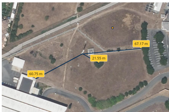
FIGURE 2.2 – Pylône d'essai et ses obstacles environnants [47]
