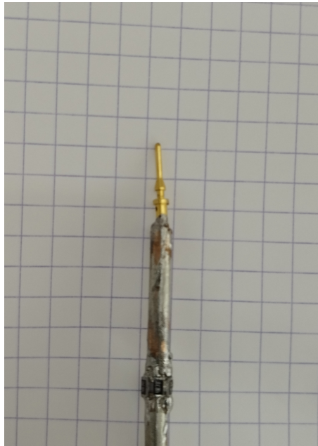
FIGURE 4.5 – Photo de la pointe avec le shunt de mesure
