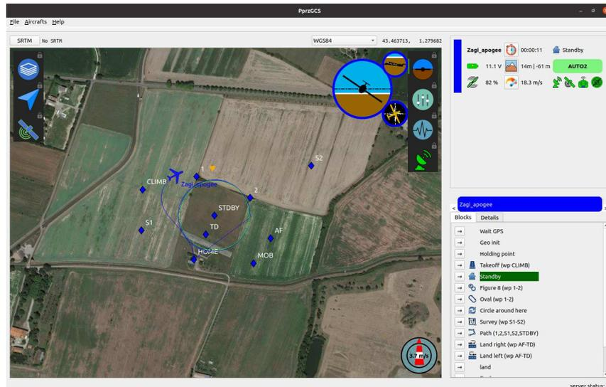
FIGURE 2.4 – Capture d'écran de la station de contrôle au sol Paparazzi
