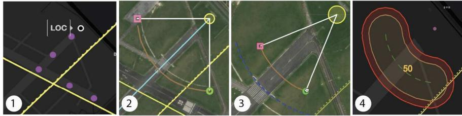
FIGURE 5.6 – Spécification d’une trajectoire *ORBIT* ou rotation autour d’un point choisi au préalable : 1) P1 choisit le point d’intérêt autour duquel orbiter, ici nommé LOC. 2) P1 ajuste le demi-angle par rapport à l’axe de la piste. 3) La trajectoire résultante est visible sur la carte et peut être ajustée à l’aide des poignées graphiques. 4) Le prototype affiche les tampons de sécurité.
