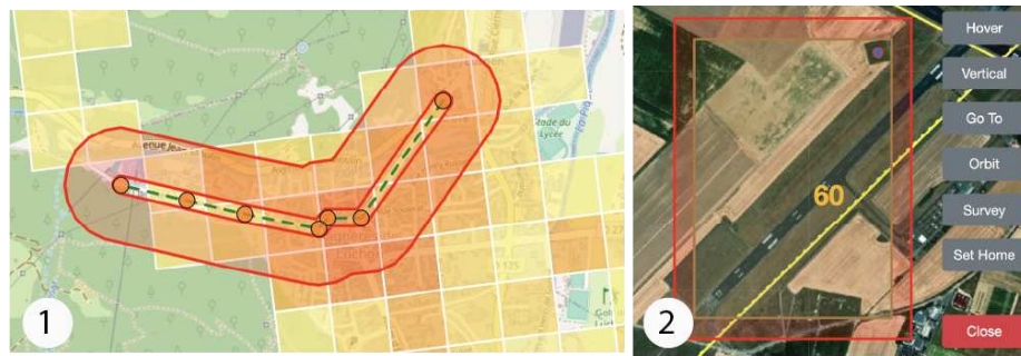
FIGURE 5.11 – 1) Extrait du cas d'utilisation de suivi, dans lequel le drone doit survoler une zone peuplée. La carte affiche la densité de population et la trajectoire prévue. 2) Extrait du cas d'utilisation de l'enquête, dans lequel un relevé automatisé d'une zone limitée doit être effectué avec une génération automatique du buffer.
