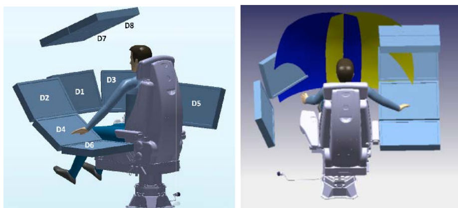
Figure 42. A gauche) maquette physique (1/2 cockpit, en position assise droite avec 8 écrans tactiles) ; à droite) zones d'accessibilité pour une interaction tactile en fonction de la norme ISO 7250
