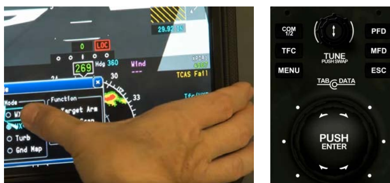
Figure 23. Interaction tactile avec stabilisation de la main sur le bord de l'écran - G500 (à gauche) Panneaux de boutons physiques permettant d'agir sur les écrans tactiles - G500 (à droite)
