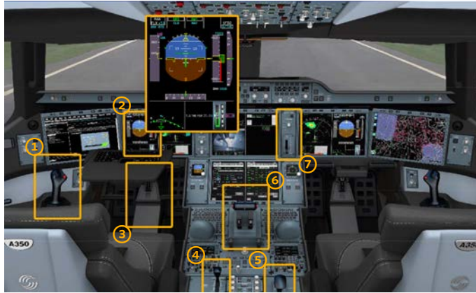
Figure 4. Instruments utilisés pour la tâche de pilotage sur l'Airbus A350 : 1/ Sidestick , 2/ Primary Flight Display , 3/ Rudder Pedals , 4/ Speed Brake Lever , 5/ Flaps Lever , 6/ Thrust Levers , 7/ Landing Gear Lever
