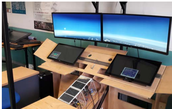
Figure 85. La plate-forme de prototypage et d'évaluation avec le prototype Multi-plié 1 positionné dans la partie centrale ( Cockpit Pedestal ).
