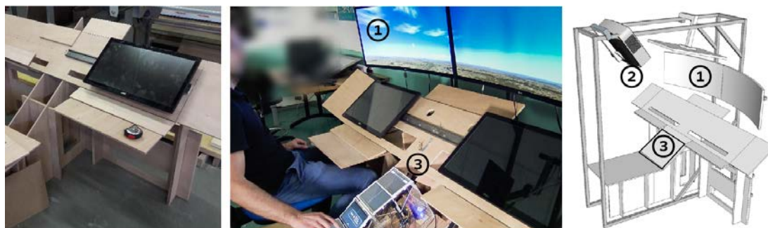
Figure 63. Le cockpit en bois ; en cours de fabrication (à gauche) ; en utilisation pour l'évaluation Multiplié (au centre) ; modèle 3D pour la fabrication avec (1) écrans courbes de 34 pouces, (2) projecteur, (3) zone d'intégration des prototypes (à droite).
