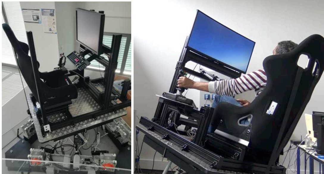
Figure 102. Simulateur cockpit dynamique, 6 degrés de liberté, pour le test des dispositifs en contextes dégradés (ex. turbulences, vibrations, accélérations)
