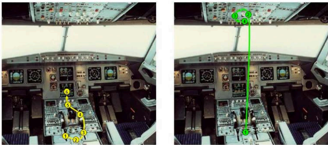
Figure 9. After Start Flow sur A320. Procédure à réaliser après le démarrage des moteurs et avant le roulage. A gauche en jaune le flow du Pilot Monitoring et à droite en vert le flow du Pilot Flying
