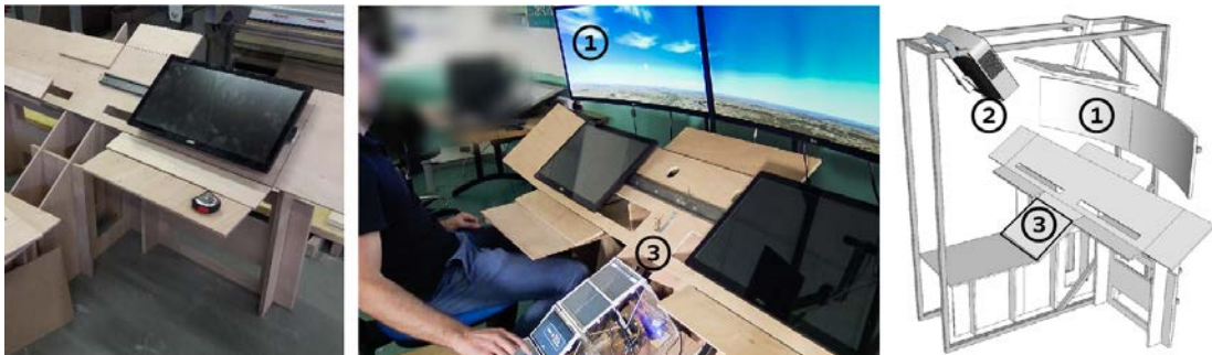
Figure 63. Le cockpit en bois ; en cours de fabrication (à gauche) ; en utilisation pour l'évaluation Multiplié (au centre) ; modèle 3D pour la fabrication avec (1) écrans courbes de 34 pouces, (2) projecteur, (3) zone d'intégration des prototypes (à droite).
