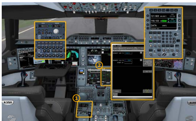
Figure 6. Instruments utilisés pour la tâche de communication sur l'Airbus A350 : 1/ Radio Management Panel, 2/ Multi-Function Display
