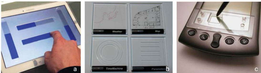
Figure 46. La surface statique augmentée ; a) Guides pour actions tactiles ; b) DataTiles ; c) Guides physiques pour limiter les effets des tremblements
