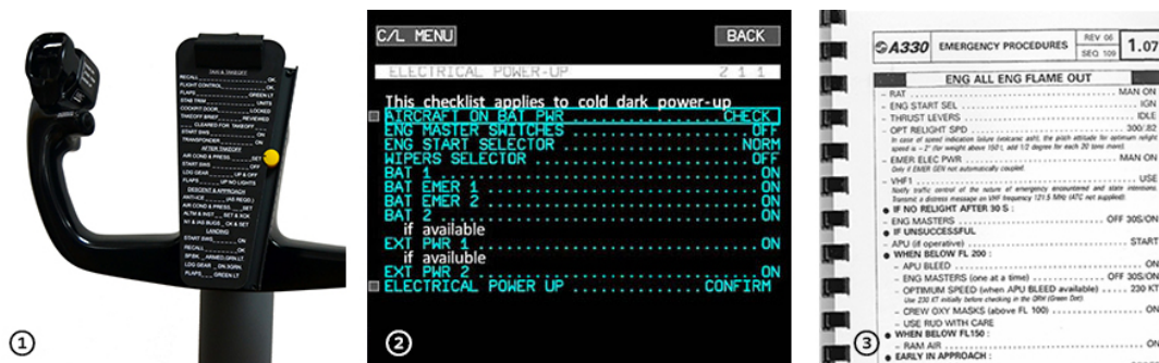
Figure 10. Exemples de check-list : 1/ sur le yoke du Boeing 737, 2/ sur écran et 3/ au dos du QRH
