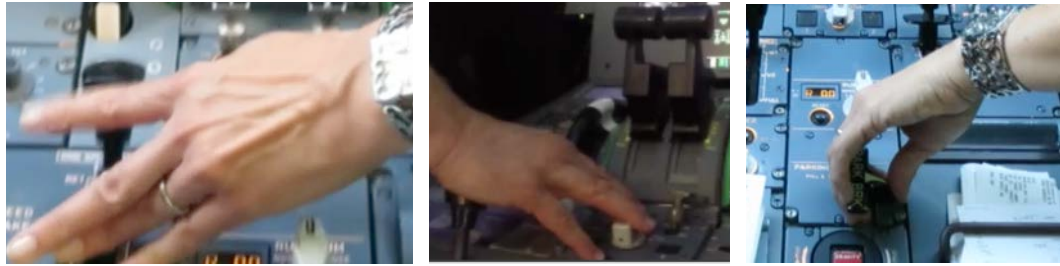
Figure 12. Utilisation des propriétés de la forme des contrôleurs physiques : a) volets ; b) APU ; c) frein de parking.
