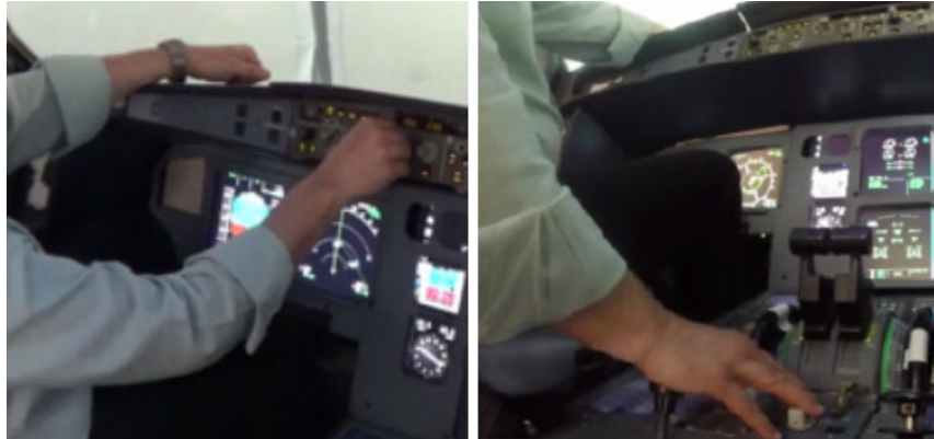
Figure 25 : Pilotes utilisant l'environnement physique comme support à l'action. A gauche, réglage progressif d'un cap au FCU en gardant la main sur le bouton. A droite, attente de l'ordre de réglage de l'APU avec la main appuyée sur la manette des volets et le doigt sur le bouton APU.
