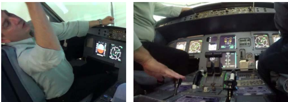
Figure 13. Gestes pour percevoir : a) contrôle de l'over Head ; b) contrôle des speed brake.
