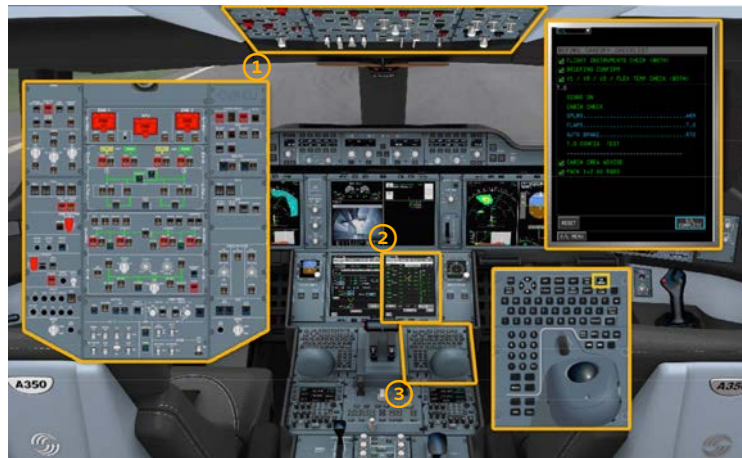
Figure 7. Instruments utilisés pour la tâche de gestion des systèmes sur l'Airbus A350 : 1/ Overhead panel, 2/ Multi-Function Display 3/ Keyboard and Cursor Control Units
