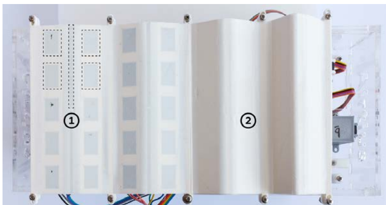
Figure 89. Vue de dessus de la surface plissable ; 1) PLA conducteur intégré dans le PLA blanc (zones en pointillées) ; 2) partie supérieure de la surface non tactilisée.
