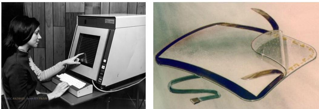
Figure 26. Écran tactile du PLATO IV, 1972 (à gauche) ; deuxième génération des écrans « AccuTouch » (à droite) ;
