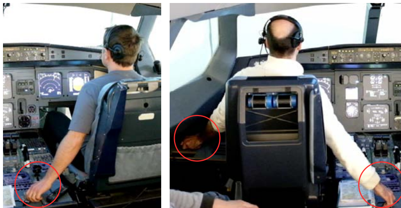
Figure 24. Actions sur le système sans le regard. A gauche, le PM règle les volets en surveillant l'extérieur. A droite le PF dirige l'avion au sol avec la main gauche sur le Steering Handwheel et contrôle le réglage des volets avec la main droite tout en regardant l'environnement extérieur
