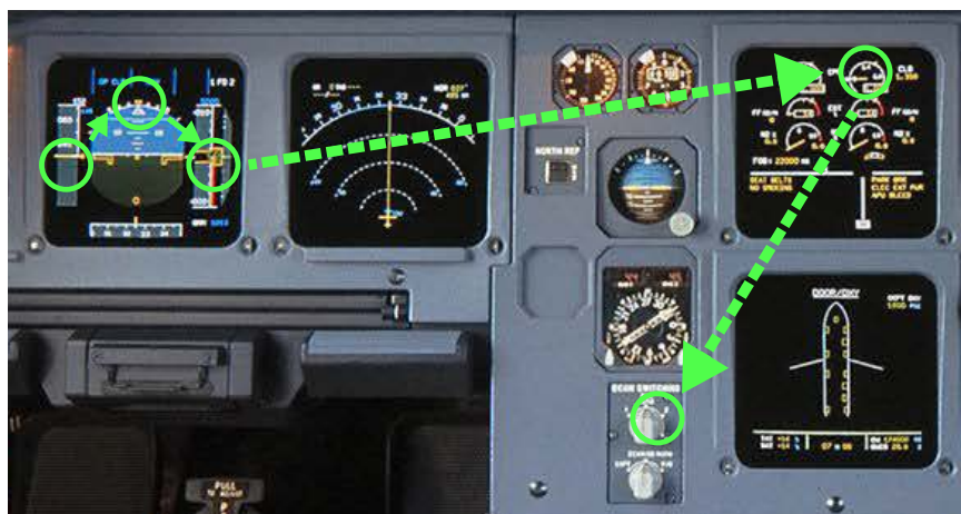
Figure 11. Représentation schématique d'une série de fixations et dwells séparés par des saccades
