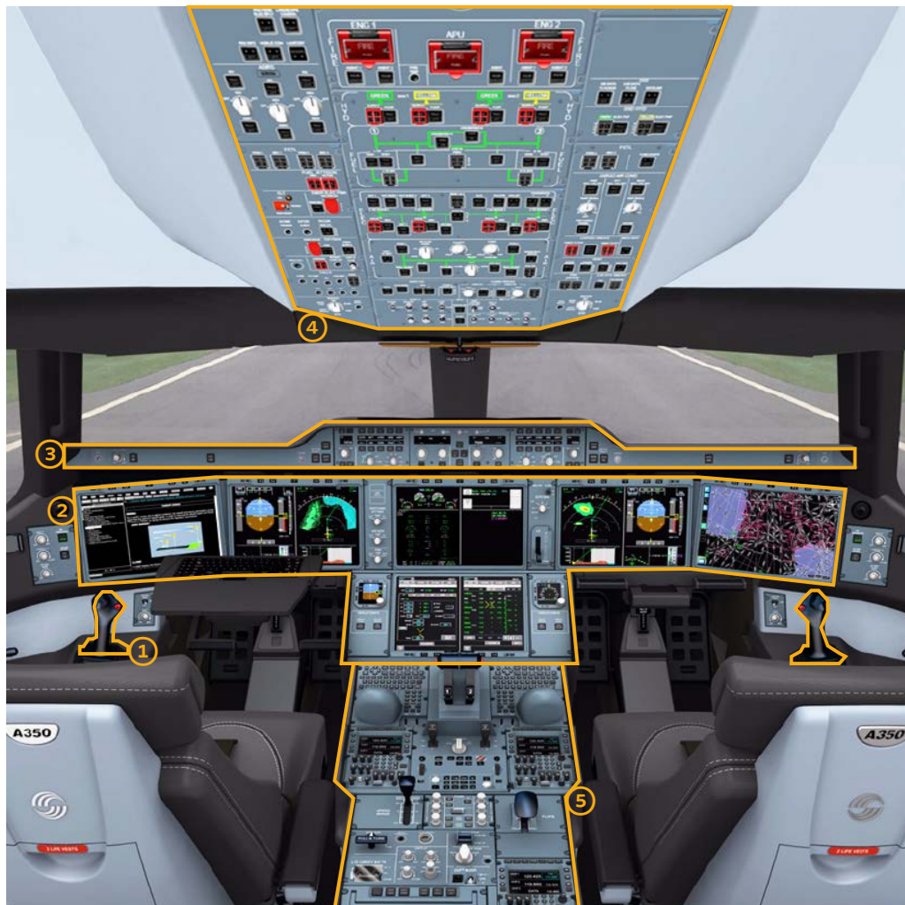
Figure 3. Les différents panneaux d'instruments dans le poste de pilotage de l'airbus A350 : 1/ Side-Stick, 2/ Main Instrument Panel, 3/ Glareshield, 4/ Overhead Panel, 5/ Pedestal
