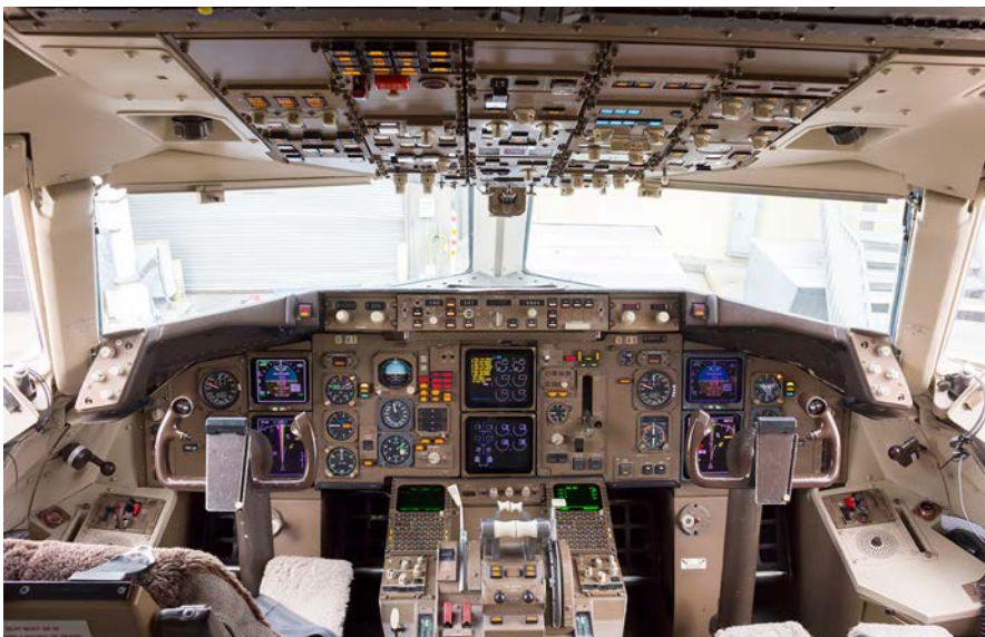
Figure 18. Première génération de Glass Cockpit – Boeing 757
