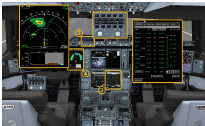
Figure 5. Instruments utilisés pour la tâche de navigation sur l'Airbus A350 : 1/ Navigation Display, 2/ Electronic Flight Instrument System Control Panel 3/ Multi-Function Display
