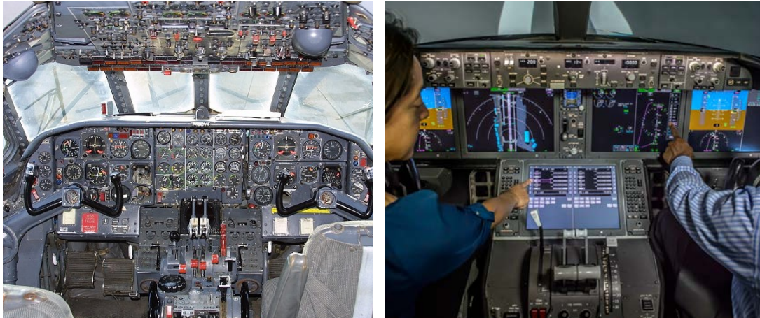
Figure 16. De l'instrument analogique à la surface tactile a/ Cockpit de la SE 210 Caravelle ; b/ Cockpit tactile du Boeing 777X
