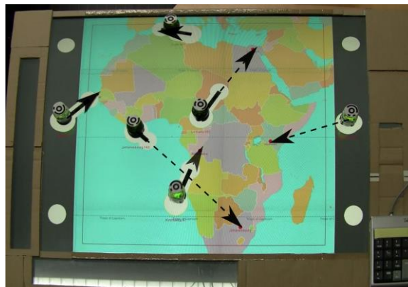
Figure 8. BotMap : des robots autonomes se déplacent de manière contrôlée sur la table pour permettre à des personnes déficientes visuelles d'explorer des cartes en manipulant le point de vue et l'échelle.
