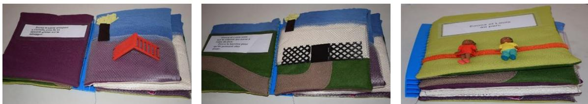
Figure 10. Le « conte sensoriel » est un livre en tissu incluant des objets imprimés en 3D et une carte microcontrôleur. Il est utilisé pour raconter une histoire incluant des expériences sonores et tactiles à des jeunes enfants déficients visuels. Les objets imprimés en 3D sont détachables et permettent d'instancier l'histoire. Des contacteurs sont dissimulés dans le livre et permettent de déclencher des narrations ou des sons pour accompagner l'histoire.
