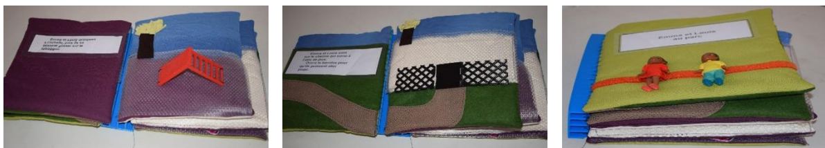
Figure 10. Le « conte sensoriel » est un livre en tissu incluant des objets imprimés en 3D et une carte microcontrôleur. Il est utilisé pour raconter une histoire incluant des expériences sonores et tactiles à des jeunes enfants déficients visuels. Les objets imprimés en 3D sont détachables et permettent d'instancier l'histoire. Des contacteurs sont dissimulés dans le livre et permettent de déclencher des narrations ou des sons pour accompagner l'histoire.
