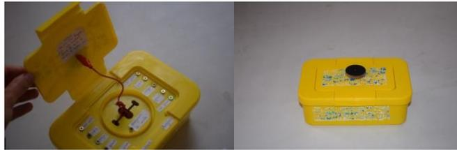
Figure 12. La boîte métaphorique est une boîte en plastique dans laquelle ont été placés une carte microcontrôleur et des têtes de vis servant de contacteurs. Le contact avec une tête de vis permet de déclencher des sons. Tous les contenus sonores sont modifiables très facilement. Elle est utilisée pour enseigner la notion de taille à des jeunes enfants déficients visuels avec des troubles associés.
