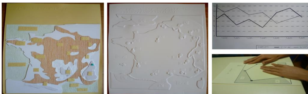
Figure 1 : A gauche : Matrice réalisé pour le thermoformage d'une carte de France. Centre : Carte thermoformée. Droite : Graphique et carte de France réalisés sur papier thermogonflable.
