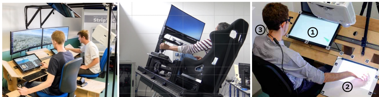
Figure 1: les plateformes de tests AIRTIUS, à gauche le simulateur « bois », au centre le simulateur « 6-axes », à droite, réalisation d'une expérimentation contrôlée avec le dispositif GazeForm
