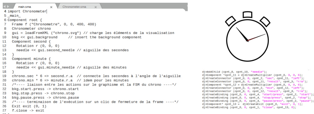
Figure 1: Code Smala, extrait du code C/Djnn et résultat de l'exécution d'un chronomètre
