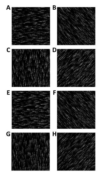
Figure 2: Flow visualization using the OLIC algorithm for flows of different directions. A) The flow angle is equal to 0°, B) 45°, C) 90°, D) 135°, E) 180°, F) 225°, G) 270°, H) 315°.
