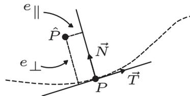
**Figure 3.** Interprétation des erreurs invariantes entre la position réelle  $P$  et estimée  $\hat{P}$
