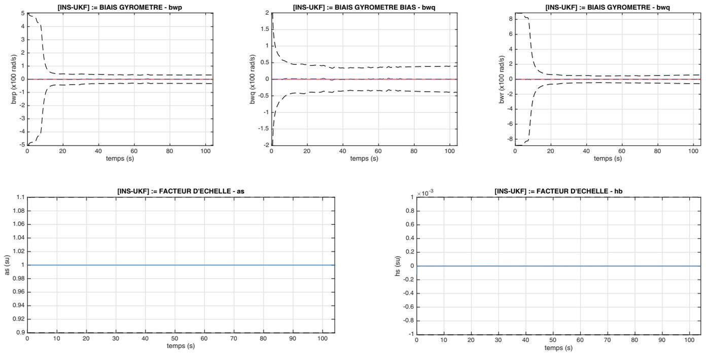
Figure 17. INS-UKF : estimation des imperfections : biais  $\omega_b$
