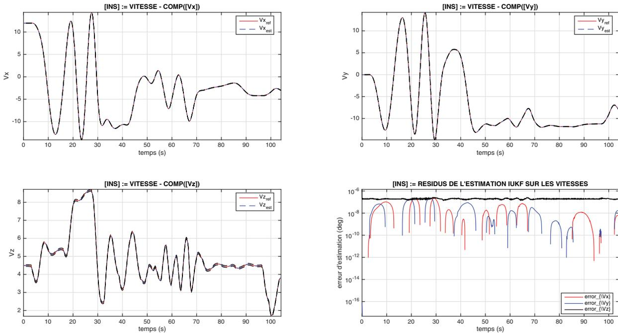
**Figure 14.** INS-IUKF : estimation des vitesses et erreurs d'estimation
