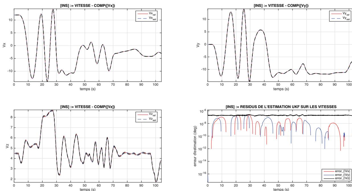
**Figure 13.** INS-UKF : estimation des vitesses et erreurs d'estimation
