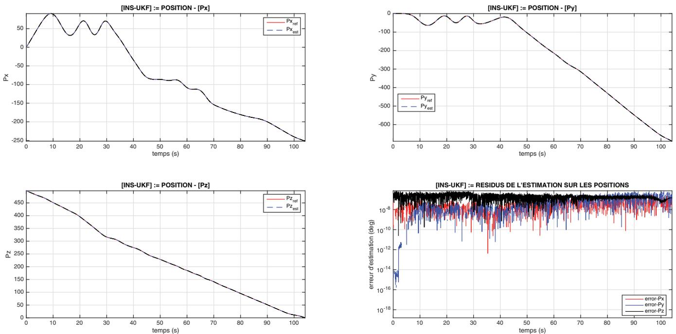
**Figure 15.** INS-UKF : estimation des positions et erreurs d'estimation
