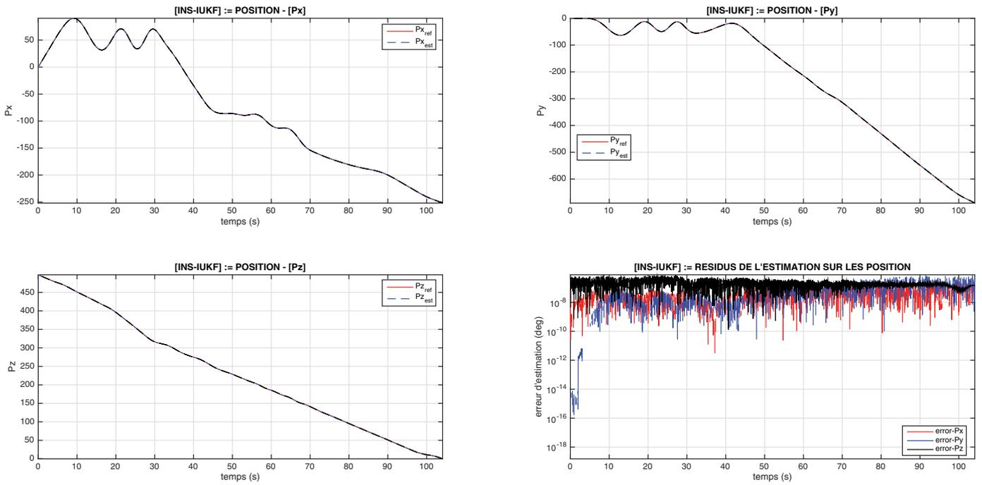
Figure 16. INS-IUKF : estimation des positions et erreurs d'estimation
