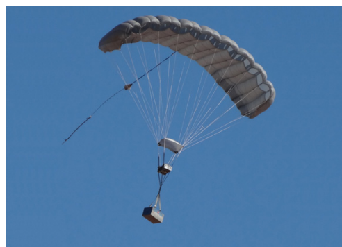
Figure 7. Modèle de parafoil développé par la NASA avec sa charge utile
