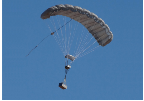
Figure 7. Modèle de parafoil développé par la NASA avec sa charge utile
