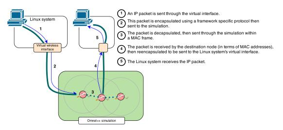
Fig. 2: The virtualmesh functionning
