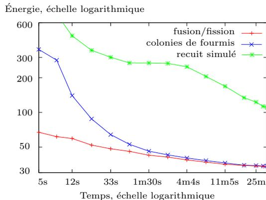
FIG. 9 – Courbes des énergies des états trouvés en fonction du temps par les méthodes d’optimisation par recuit simulé, par colonie de fourmi hybride et par fusion/fission, appliquées au problème de découpage du ciel aérien européen
